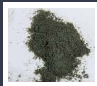
3 PULVERIZACIÓN A 200 µm EN EL CRYOMILL
