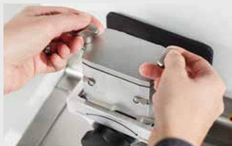
Fig. 3: Los innovadores recipientes Screw-Lock son muy fáciles de usar y pueden fijarse al molino en cuestión de segundos. Estos pueden mantenerse fijados al molino y abrirse para tomar una fracción de la muestra o ver el avance del proceso de molienda.
