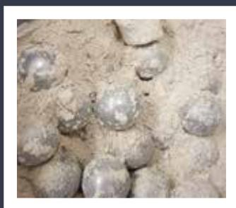
140 g getrocknete Pilze wurden in 90 min bei 60 min<sup>-1</sup> mit 10 kg Stahlmahlkugeln à 20 mm auf eine Endfeinheit von 100 µm zerkleinert.
