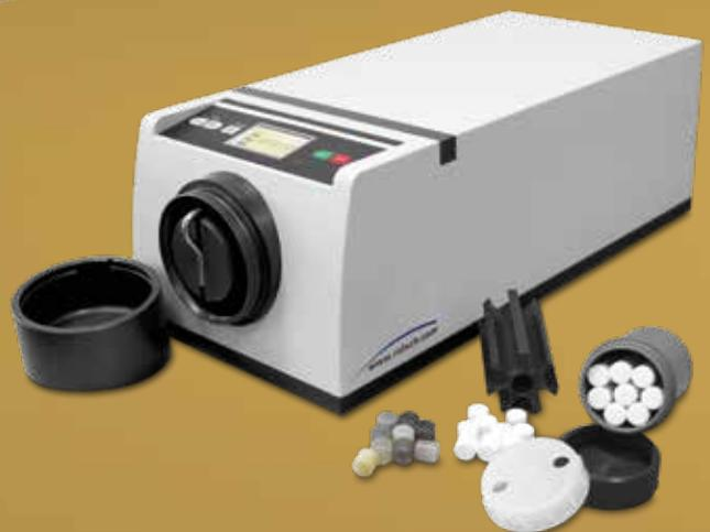
Die Mahlwerkzeuge bestehen aus 48 zylindrischen Mahlkörpern mit einer Größe von ca. 12x12 mm. Der Werkstoff wird entsprechend der Anwendung gewählt: Zirkonoxid, Korund oder Achat. Viele kleine Mahlkörper bieten deutlich mehr Kontaktpunkte als, zum Beispiel, Mahlkugeln gleicher Größe. Die Mahlkörper gleiten aneinander entlang, prallen bei den kreisförmigen Schwingungen der Mühle aber auch ineinander.
