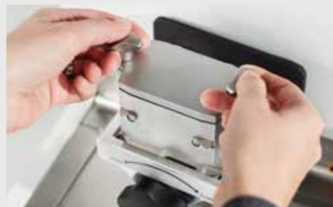
Abb. 3: Die innovativen Screw-Lock Mahlbecher sind einfach in der Handhabung und lassen sich in Sekundenschnelle verspannen. Sie können für die Probenentnahme oder Sichtprüfungen in der Verspannung verbleiben.
