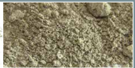
e dopo una macinazione fine nell' MM 400 giara in acciaio inox 50 ml, sfera in acciaio inox 1x25 mm, 30 Hz, 2 min
