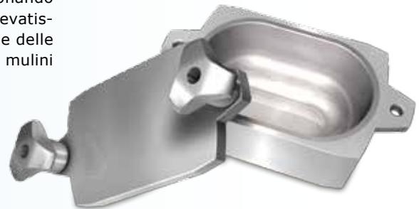
Fig. 3: La speciale geometria delle giare assicura una migliore miscelazione del campione.
